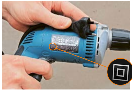
1 Bohrmaschine der Schutzklasse II mit entsprechender Kennzeichnung.
